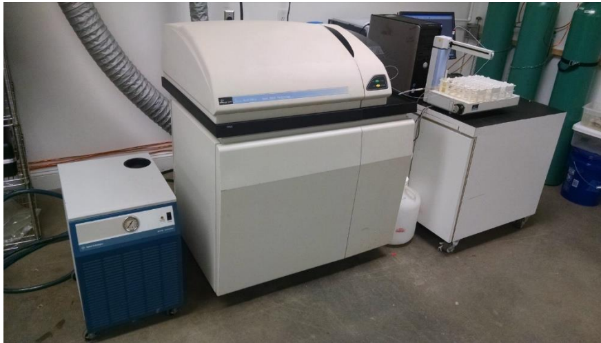
Figura 4. ICP-MS Perkin Elmer Elan DRC-e utilizado en este trabajo 12 .
