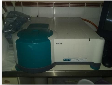
Imagen 10. Espectrofotómetro utilizado para la lectura de absorbancias perteneciente a la Universidad de las Islas Baleares (UIB) Marca VARIAN y modelo CARY 50 Conc UV-Visible spectrophotometer. [5]
