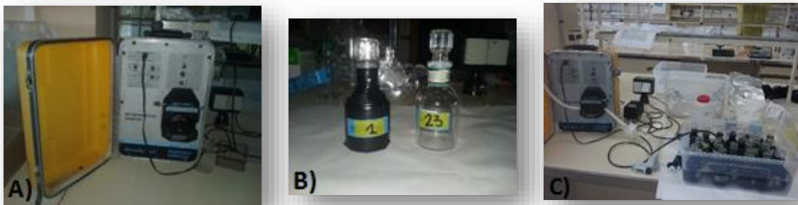
Imagen 9. A) Bomba peristáltica portátil de la Universidad de las Islas Baleares (UIB). B) Botella Winkler oscura (WB) a la izquierda y blanca (WW) a la derecha. C) Fotografía del momento de llenado de las botellas Winkler para no formar burbujas. [5]
