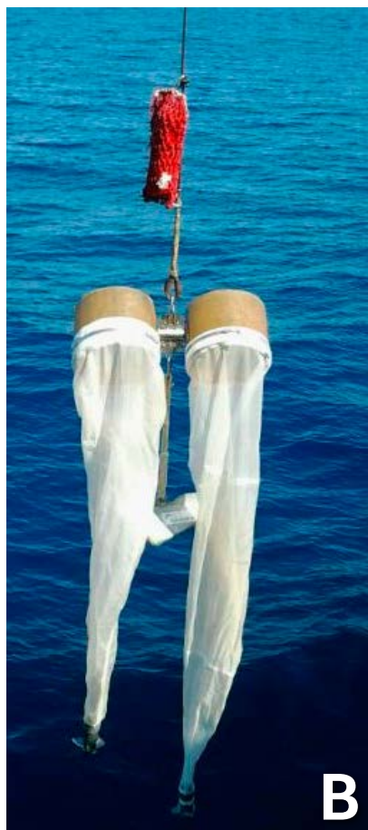
Figura 1.6: Muestreadores empleados en muestreos de plancton. A: Botella oceanográfica. B: Red de plancton Bongo 40. C: Red de plancton Bongo 90. A:CK Denmark A/S.
