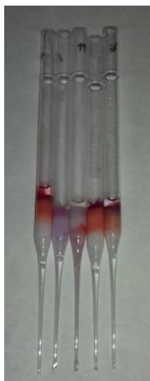
Figura 14. Mini-columnnes C18-RP per l'anàlisi dels temps de retenció. S'observen 3 fraccions amb tonalitats més vermelloses corresponents a mesclades d'àcid cobíric i neocobíric. Les 2 fraccions més violetes es corresponen amb les cobinamides.
