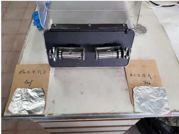
Figura 8: Molinillo Retsch mm200 con muestras de *Deschampsia antarctica*.
