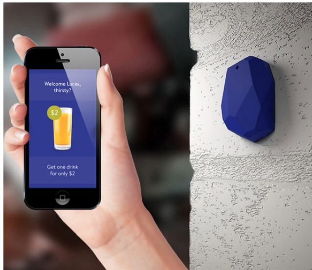
Figura 2.2: Mòbil i transmissor Beacon
