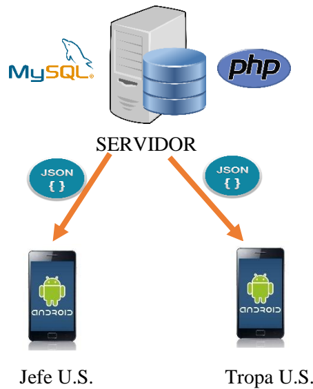
Figura 1. Esquema de funcionamiento del proyecto
