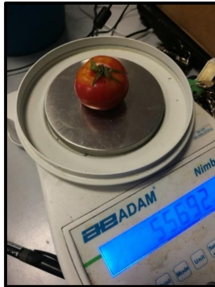
Figura 4-12 Imatge de la balança de precisió emprada per pesar les tomàtiques (Nimbus ADAM).
