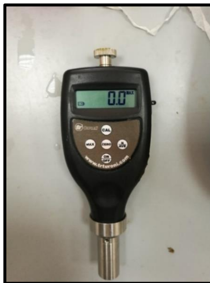
Figura 4-13 Imatge del duròmetre utilitzat per mesurar la duresa dels fruits (Laboratori Aula CAM, UIB).
