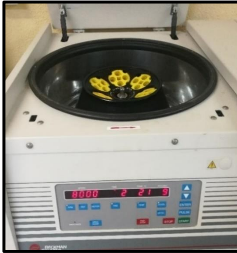
Figura 4-16 Imatge d'una centrifugadora emprada per clarificar les mostres dels Falcons (Laboratori d'Enologia, UIB)
