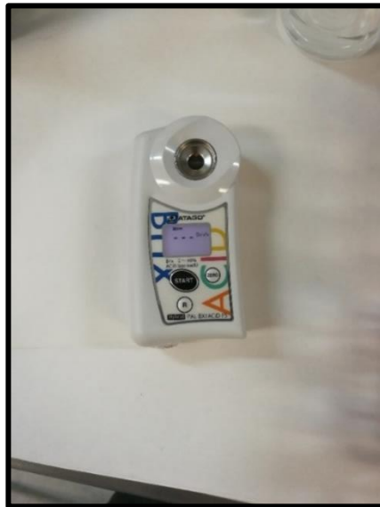
Figura 4-18 Refractòmetre digital i conductímetre elèctric (PAL-BXACID F5, Atago, Tokyo, Japó), per a la mesura de la concentració de sucres i acidesa.
