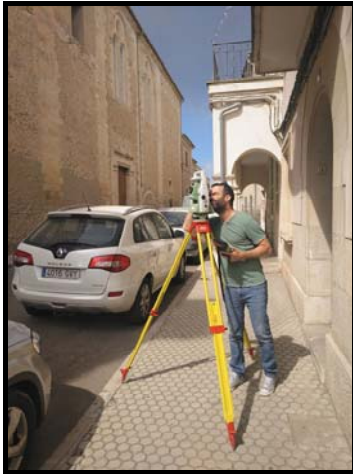
Fig. 72 - Treballant amb l'estació total a l'exterior de l'església.
