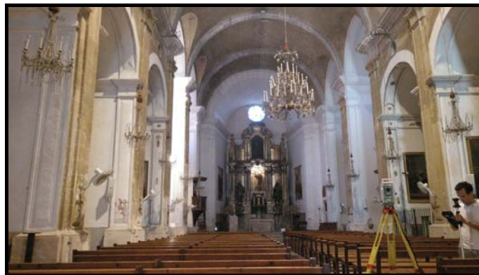
Fig. 74 - Treballant amb l'estació total a l'interior de l'església (2).
