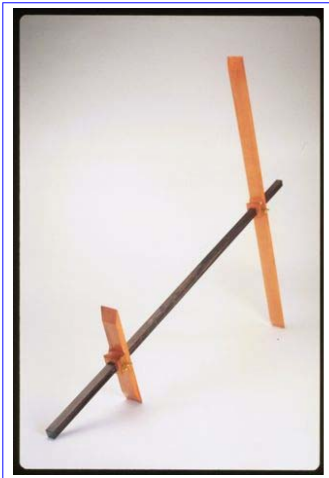
Fig. 63. La balestriglia (o ballestriglia o Bastone di Giacobbe ).
