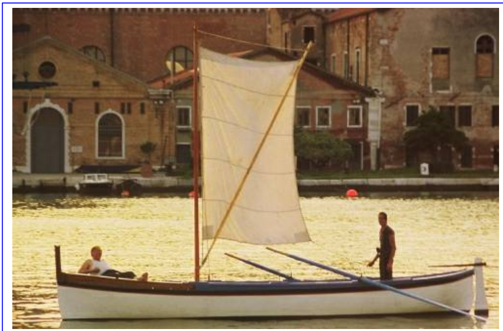
Fig. 19. Gozzo sorrentino (Marina Grande) armato con vela a tarchia (foto S. Medas).
