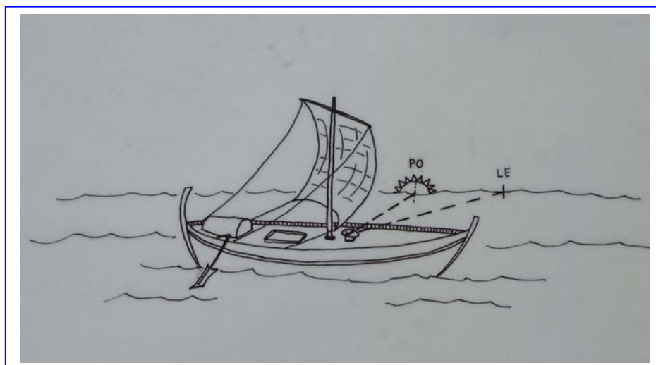
Fig. 59 (nei due riquadri). Impiego di una “bussola solare” antica, secondo la ricostruzione dello strumento ipotizzata nella figura precedente, per rilevare il Levante vero. PO = punto ortivo del sole, Levante relativo al giorno in cui si esegue il rilevamento. LE = Levante equinoziale o vero (disegni S. Medas).
