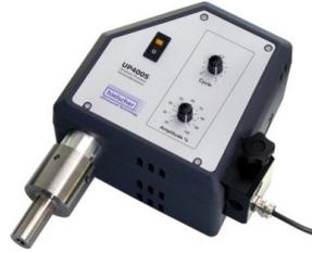
Figura 3.4. Generador de ultrasonidos UP400S.
