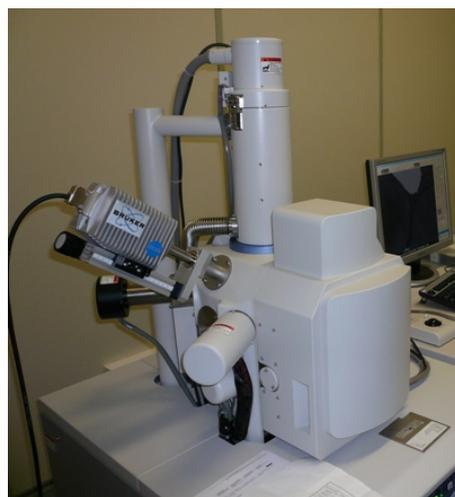
Figura 3.8. Microscopio Electrónico de Barrido HITACHI S-3400N.
