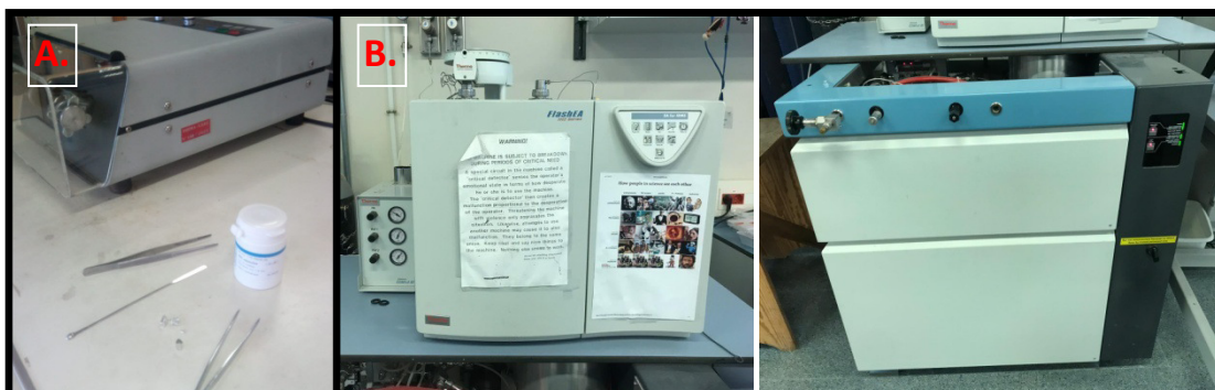
Fotografía 3. Material necesario para hacer alícuotas de polvo de uva (A): molinillo, pinzas, espátula y cápsulas. Analizador elemental y espectrómetro de masas con relación de isótopos de flujo continuo (B).
