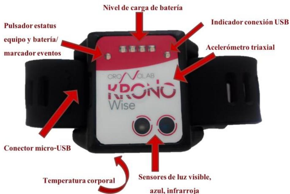
**Figura 7:** Dispositivo multisensor de muñeca Kronowise KW6 (Kronowise©, Universidad de Murcia) utilizado para la obtención de los registros utilizados para evaluar los parámetros circadianos.
