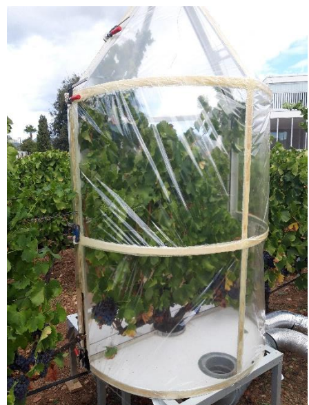
Fotografía 4 Cámara de 3,36 m3 recubierta por un film de plástico (RX 140-PropafilmTM).
