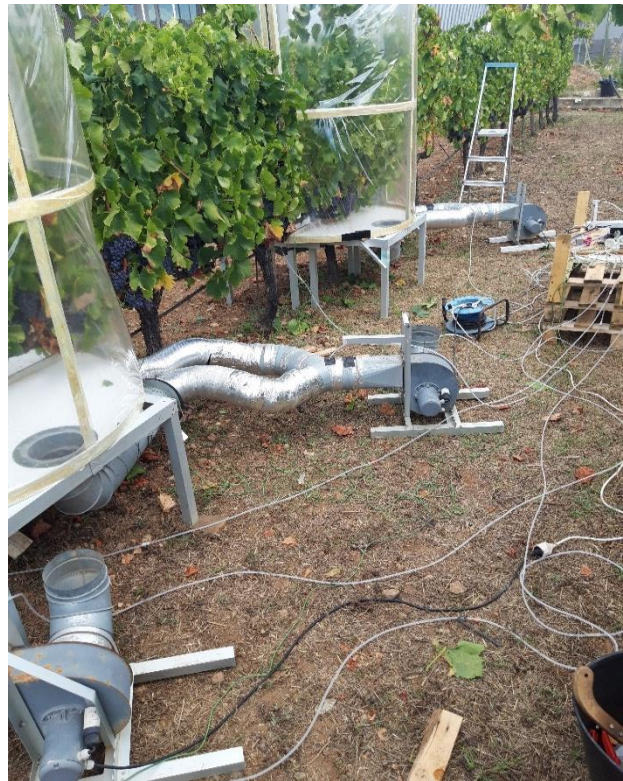
Fotografía 3 Cámaras conectadas a las turbinas de aire.
