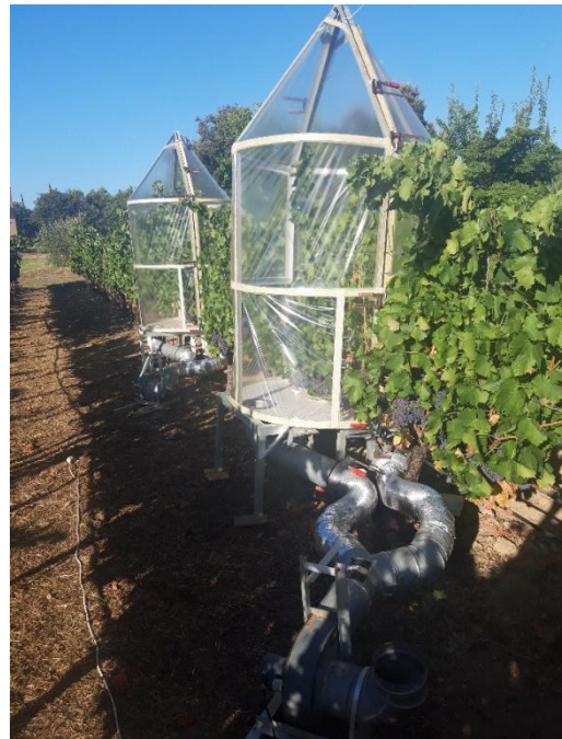
Fotografía 2 Cámaras conectadas a las turbinas de aire.
