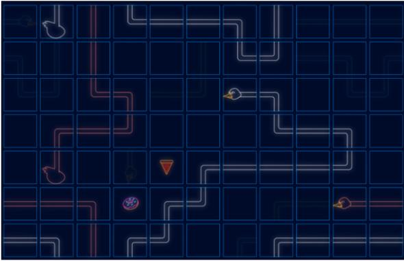
Figura 12: El agente de color rojo, con MCTS de 1000 simulaciones a profundidad de 4, no es capaz de detectar que se está metiendo por un camino sin salida y, finalmente, acaba colisionando.
