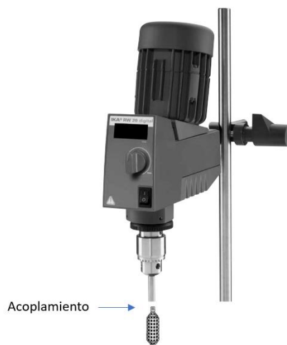
Figura 5. Esquema de acoplamiento del dispositivo impreso al rotor.
