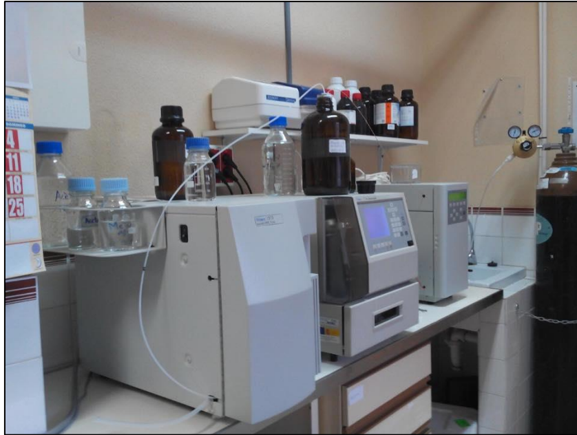
Figura 8. Dispositivo real utilizado para la ejecución del HPLC. Imagen obtenida en el laboratorio de Fisiología.
