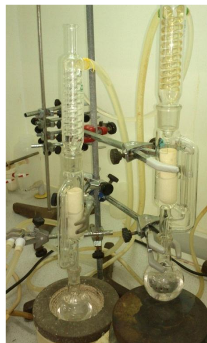
Figura 4.4. Fotografía del montaje de extracción Soxhlet utilizado para los blancos
