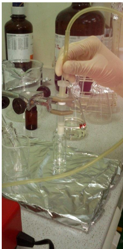
Figura 4.5. Fotografía del proceso de clean-up y el sistema de bombeo de aire
