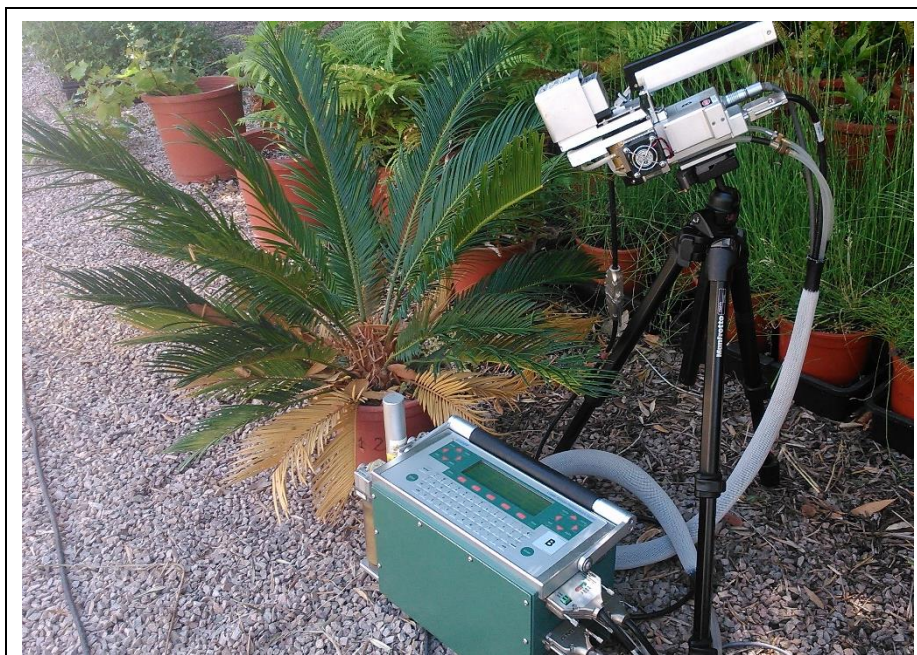
Figura 4. Presa de dades amb el Li-cor 6400 (incloent la càmera de fluorescència 6400-40) a un individu de Cycas revoluta .
