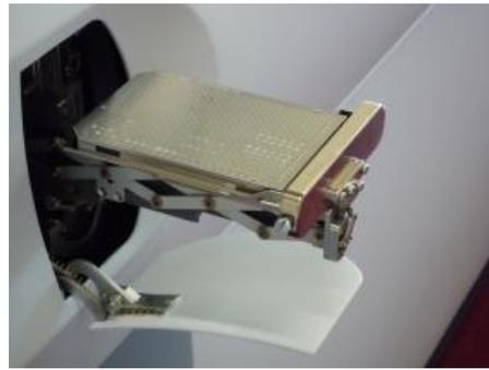
Figura 3: Placa MALDI-TOF y sistema de introducción de la placa en el espectrómetro de masas MALDI-TOF
