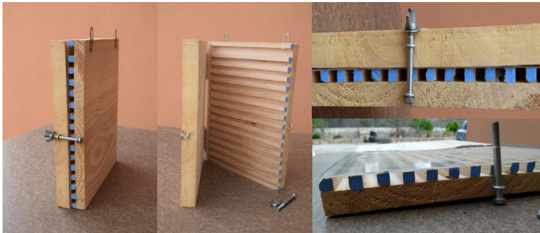
Figura 2. Cambra d'observació per la nidificació d'abelles solitàries. Consta de diferents llistons aferrats a una taula de fusta que deixen una obertura d'1cm. S'ha pintat de blau clar per atreure les abelles. 23x31x5 cm.
