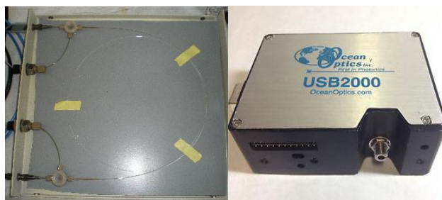
Figura 2.6. Componentes del sistema de detección espectrofotométrico: (izq.) celda capilar de largo paso óptico y (der) espectrofotómetro miniaturizado Ocean Optics USB2000.
