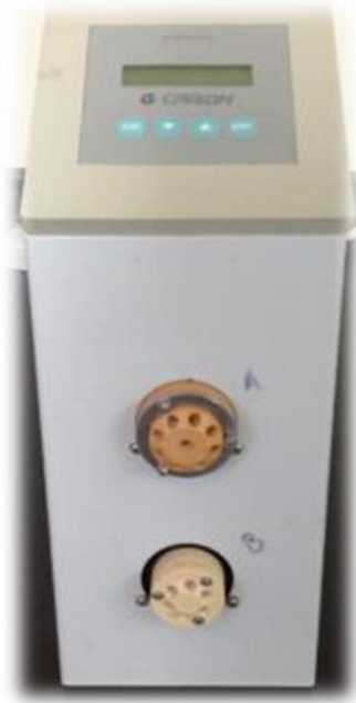
Figura 4.2. Módulo de válvulas de selección/inyección Pump 2060 (Crison Instruments, España).
