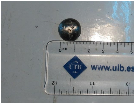
Figura 3. Imatge de la mostra després de refondre-la al forn d'arc.
