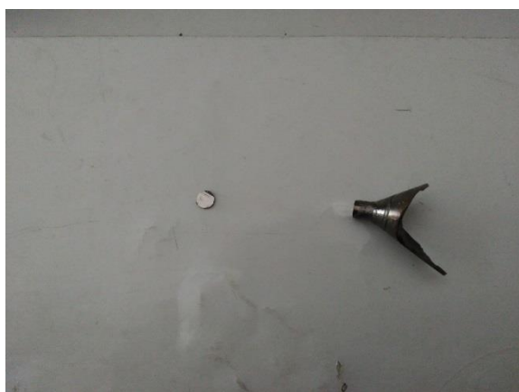
Figura 2. Cap (forma de con) i peu tallats de la mostra inicial fosa al forn d'inducció.
