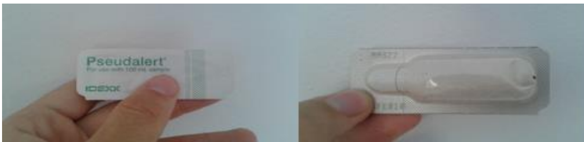
Figura 1.- Cápsulas de reactivo Pseudalert® para la utilización en base a 100mL de muestra.
