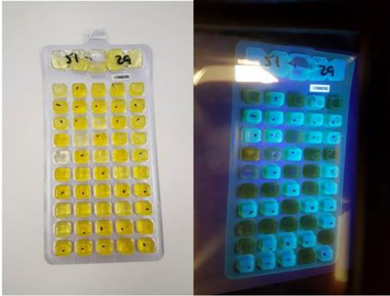
Figura 2.- A la izquierda, los resultados obtenidos de una muestra de agua de recreo sin fluorescencia. A la derecha, los mismos resultados sometidos a luz UV.
