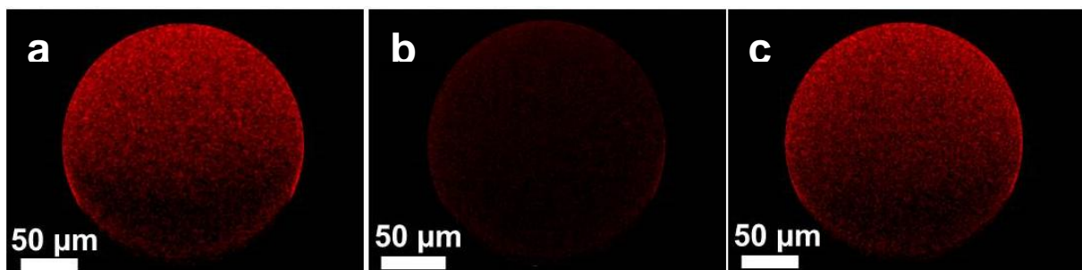
Figura 3.10. Mapa de distribución de carbono en las esferas sin recubrir (a), las esferas recubiertas con óxido de zinc (ZnO) (b), y las esferas recubiertas con una doble capa de óxido de zinc y ZIF-8 (ZnO@ZIF-8) (c).
