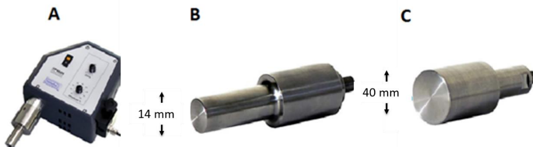
Figura 3.6: A- Procesador de ultrasonidos de potencia UP400S. B- Sonda de 14 mm de diámetro. C-Sonda de 40 mm de diámetro.
