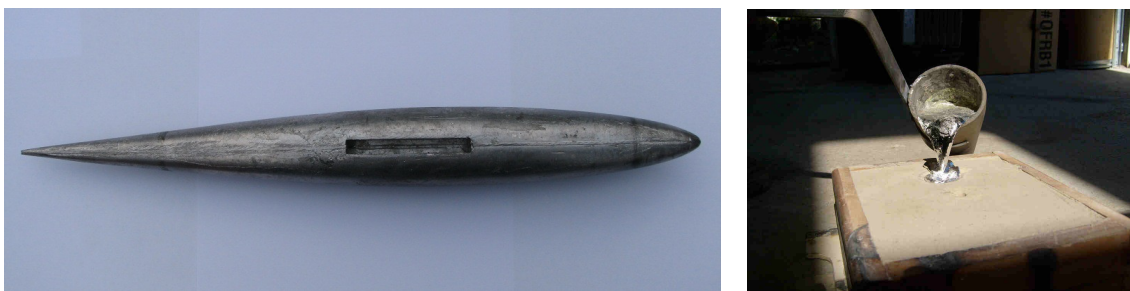
Imatge 9: El bulb de llastre es pot fabricar amb colada amb motlle d'arena
