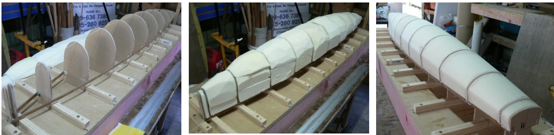
Imatge 8: Exemple constructiu del veler classe 1m internacional
