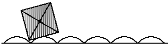
Imatge 4.1.1. Roda quadrada sobre catenària invertida. Font: http://web.mst.edu
