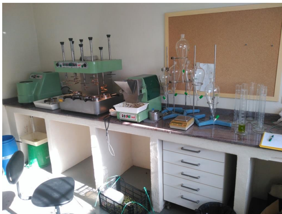
Ilustración 9. Sistema ABENCOR utilizado en la extracción de aceite (Fuente: Propia).
