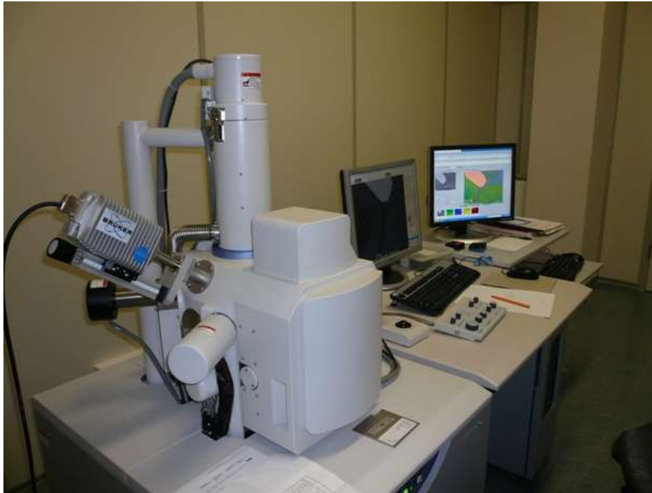
Figura 6. Microscopi Electrònic d'Escombratge HITACHI S-3400N dels Serveis Científicotècnics de la Universitat de les Illes Balears (UIB). Té un voltatge d'acceleració de 0,5 a 30 KV i una capacitat de magnificació de 20 a 300.000 augments. A més, consta d'un portamostres motoritzat [25].
