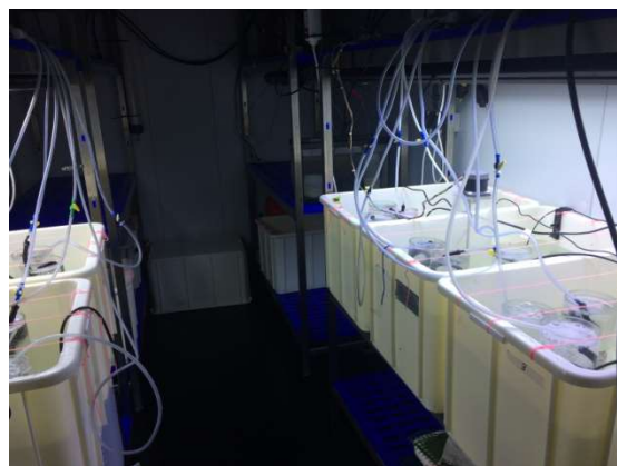
Figura 4: Montaje de los 5 tanques con los testigos de sedimento y los aireadores.
