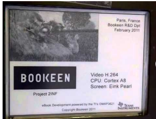
Figura 4: Imagen de reproducción de vídeo con tecnología eInk en escala de grises. Fuente: Youtube.com (“Bookeen displays smooth vídeo playback on eInk Panel,” 2011)
