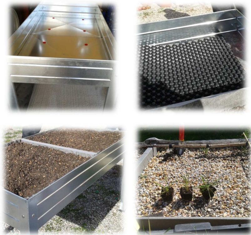
Figura 3.3. Instalación de los módulos experimentales con los componentes comerciales del sistema de cubierta ajardinada Empresa proveedora: Proyectos paisajísticos Baleares S.L.PPB, Mallorca España.
