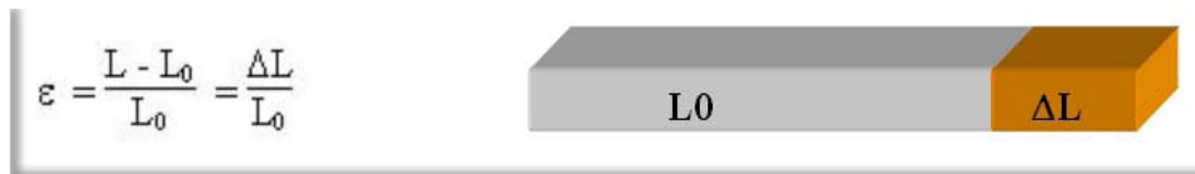
Fig 9. Cálculo del strain ( \epsilon ), con L_0 como longitud original (barra gris), \Delta L el cambio en la longitud (barra naranja) y L la longitud total (barra gris y naranja) 81 .
