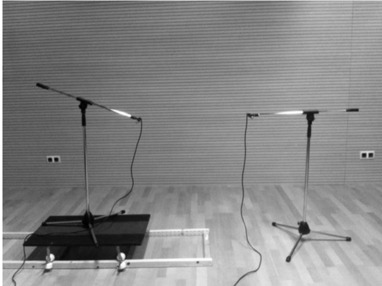
Figura 30 Técnica estéreo AB en una cámara reverberante.
