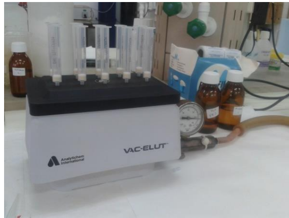
Figura 10. Sistema SPE utilizado para la pre-concentración de DCF y sus productos de transformación.
