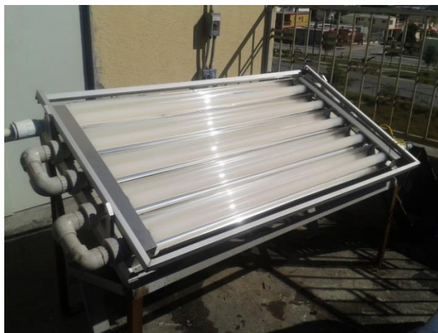
Figura 7. Reactor tipo CPC usado para la degradación de diclofenaco a escala semipiloto.
