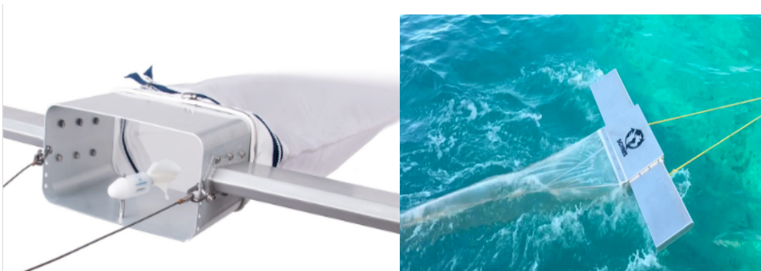
Imatge 2: Esquerra: xarxa Manta de HydroBios GmbH (extret de https://www.hydrobios.de/de/produkt/manta-fur-mikroplastik/ ). Dreta: xarxa Manta en funcionament (extret del video “Manta Trawl on the Bahama Banks for the 5 Gyers Trawlshare Program” publicat el 8 de gener de 2018 al canal de YouTube “Sailing Swains”, disponible a https://www.youtube.com/watch?v=SIGj2tMLPAg ).
