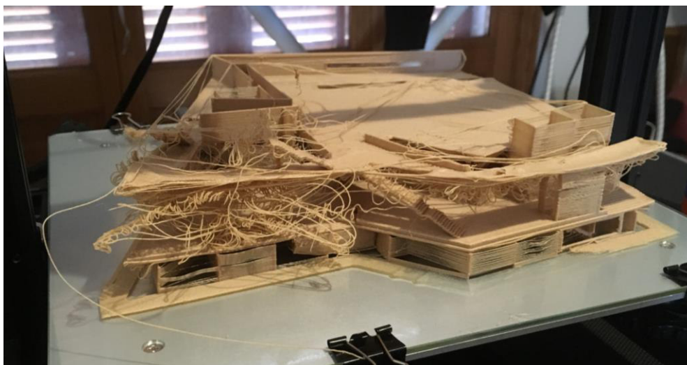
Primer error, produït quan la impressora duia 31 hores en funcionament
