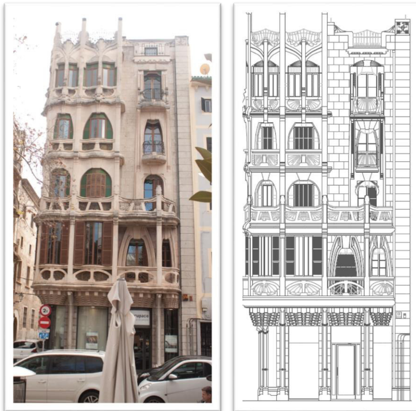
Aixecament fotogramètric emprant Homògraf per Autocad de Façana de Can Casasayas (Palma de Mallorca)
