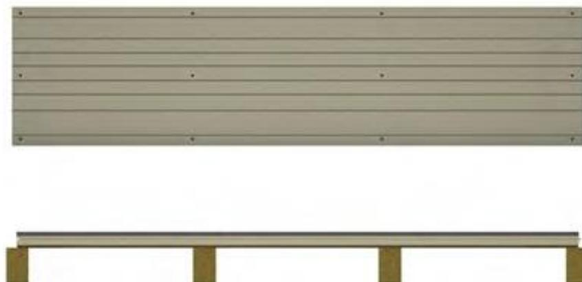
8. La fijación se realiza de forma mecánica. Las fijaciones deberán estar colocadas a no menos de 3 cm. del borde del panel introduciendo estas de forma oblicua preferiblemente.
