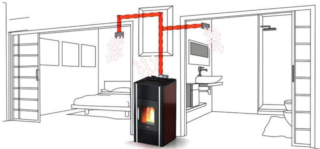
El conducto de salida de humos del grupo térmico de calefacción se realizará con un tubo de doble pared de acero inoxidable AISI 316L de 150 mm de diámetro y pared exterior de acero aluminizado, con aislamiento entre paredes mediante manta de fibra cerámica de alta densidad de 25 mm de espesor.
