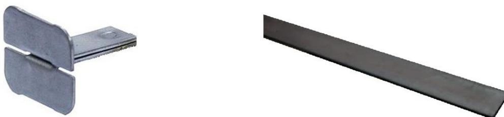
Los anclajes o sujeciones serán metálicos como los de una fachada ventilada. Al tratarse de una solución especial los realizará un herrero mediante la unión de una pletina de acero y un anclaje similar al de las fachadas ventiladas. Este anclaje irá soldado a los perfiles HEB 100. Una vez colocados se pintarán con la misma pintura intumescente que los perfiles HEB 100.
