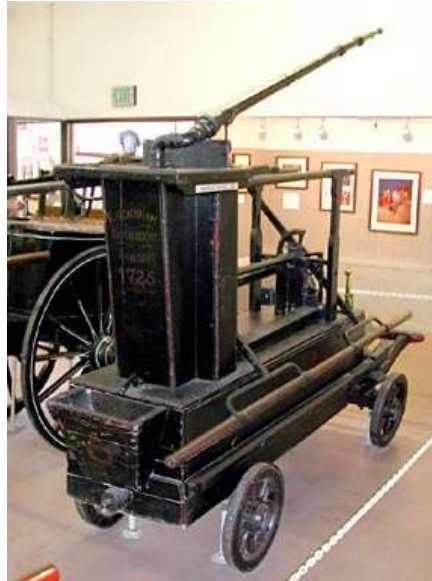
Figura 8. Ejemplo de las primeras bombas de impulsión
