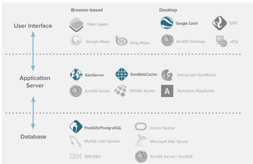
Figura 2.1: Comparación de las tecnologías posibles para posicionar información sobre el mapa. Obtenido en [1].
