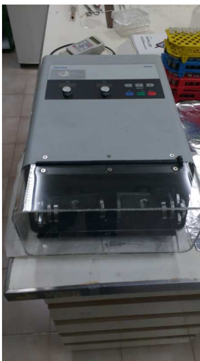
Figura 3-12. Imatge del molinet de laboratori Retsch MM200 usat per a capolar les mostres. (Laboratori de Fisiologia Vegetal, Edifici Guillem Colom Casanovas, UIB).
