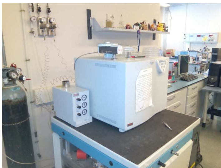
Figura 3-14. Imatge de l'espectròmetre de masses Thermo-Finnigan Delta XP emprat per analitzar els isòtops. (Laboratori de Fisiologia Vegetal, Edifici Guillem Colom Casanovas, UIB).
