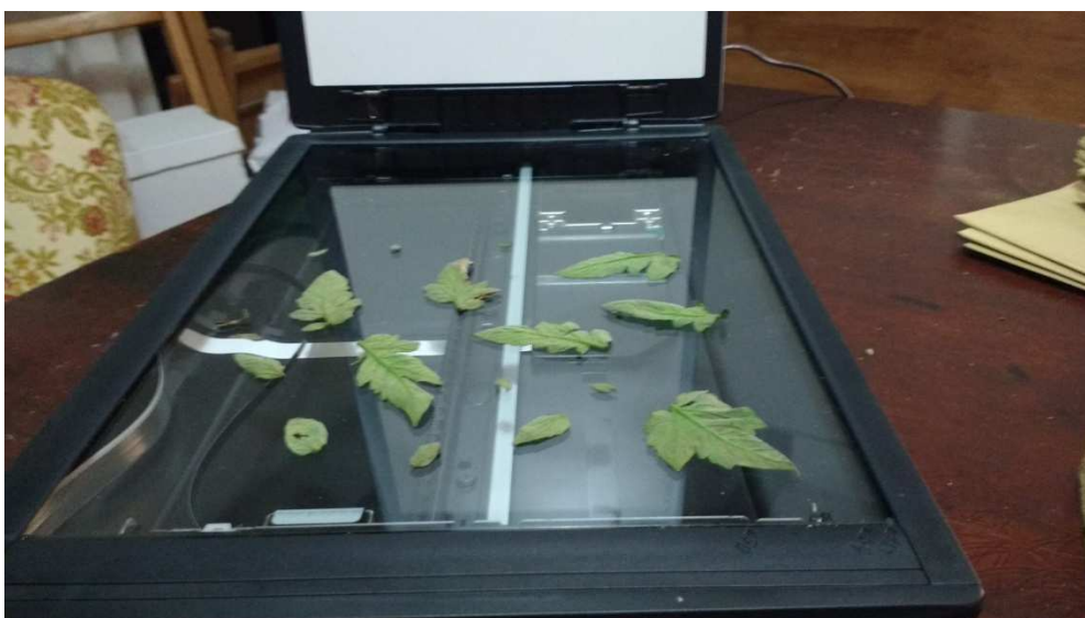
Figura 3-7. Imatge de l'escàner (Canon CanoScan LiDE 220) utilitzat per obtenir les àrees de les diferents fulles de les plantes.
