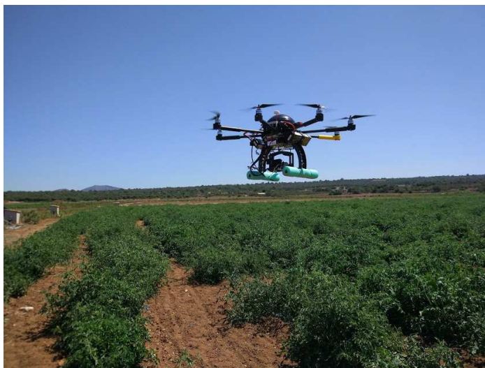
Figura 3-15. Imatge del dron (FV8, Atyges, Màlaga, Espanya) durant l'inici del vol en el camp on es realitza l'estudi, equipat amb una càmera RGB de 16 mm (Alpha 5000, Sony, Tòquio, Japó) i un pilot automàtic (AP04, UAV Navigation Madrid, Espanya).
