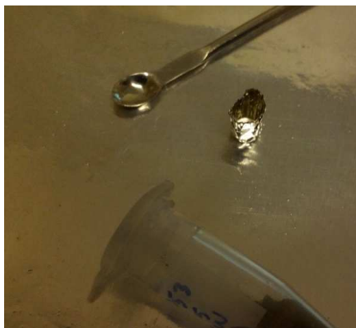
Figura 3-13. Imatge de l'encapsulació d'una mostra al recipient d'alumini des de l'eppendorf. (Laboratori de Fisiologia Vegetal, Edifici Guillem Colom Casanovas, UIB).
