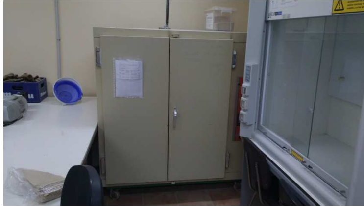
Figura 3-10. Imatge de l'estufa a 74°C amb les mostres (Laboratori de mostres, Edifici Guillem Colom Casanovas, UIB).
