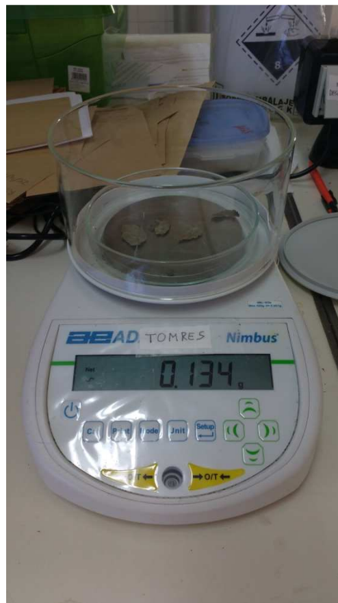
Figura 3-11. Imatge de la balança de precisió Nimbus ADAM emprada per a pesar mostres seques (Laboratori de Fisiologia Vegetal, Edifici Guillem Colom Casanovas, UIB).
