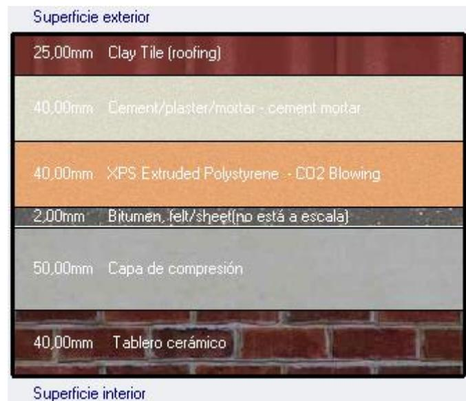
Figura 31. Sección cubierta inclinada.
