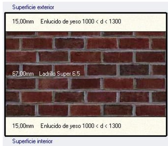
*Figura 27. Sección partición interior.*
