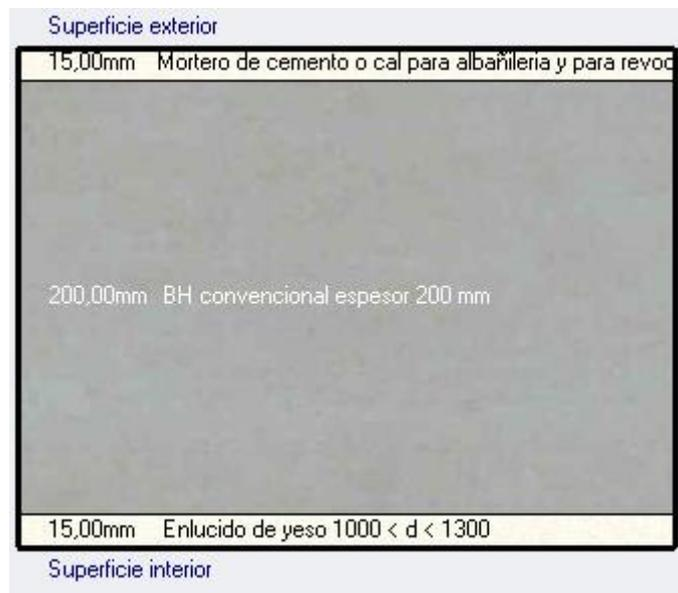
Figura 25. Sección muro exterior
