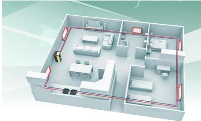
*Figura 71. Circuito de radiadores con hidroestufa.*
