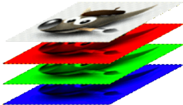
Figura 2.2: Síntesi additiva de color RGB: Capes dels colors primaris que conformen la imatge final. Font: https://docs.gimp.org
