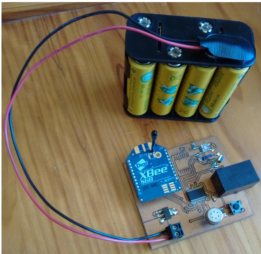
Figura 3.15: Vista general del node amb l'alimentació.
