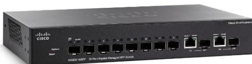
Ilustración 7. Switch Fibra Óptica
