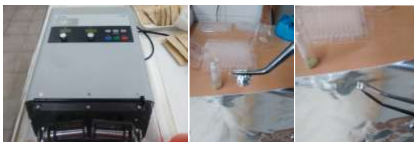
Figura 15. Moli mesclador al qual es van polvoritzar les mostres de fulla seca i procés d'encapsulat de les mostres, on es mostra el moment de tancat de la càpsula i de formació de l'esfera.
