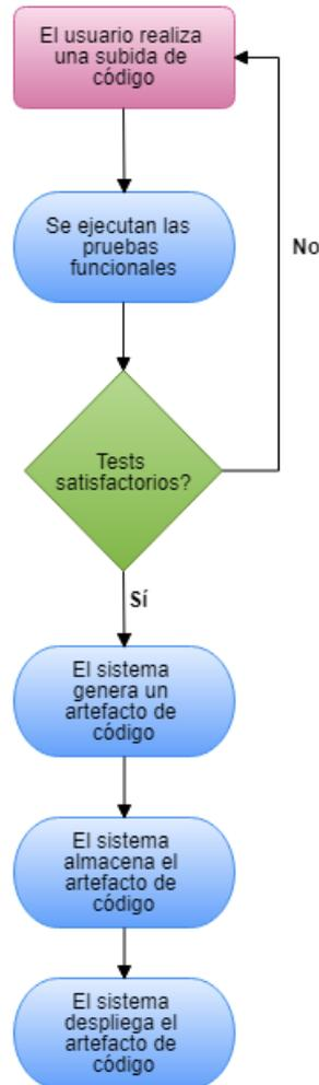
Figura 2.2: Diagrama de flujo del proceso de CI/CD llevado a cabo por el sistema.
