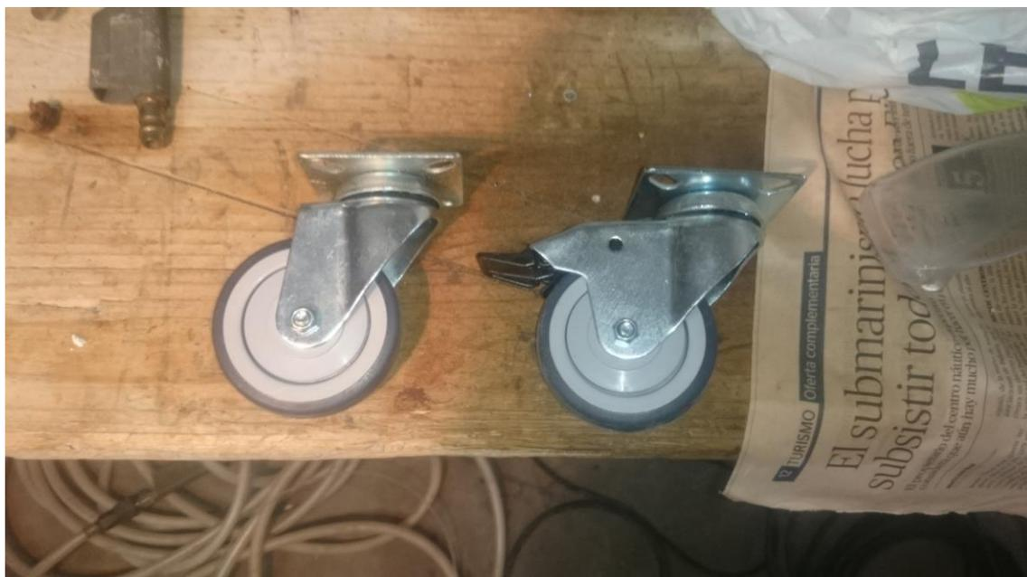
Imagen 7: Elección de ruedas delanteras (izquierda) y traseras (derecha) para estructura
