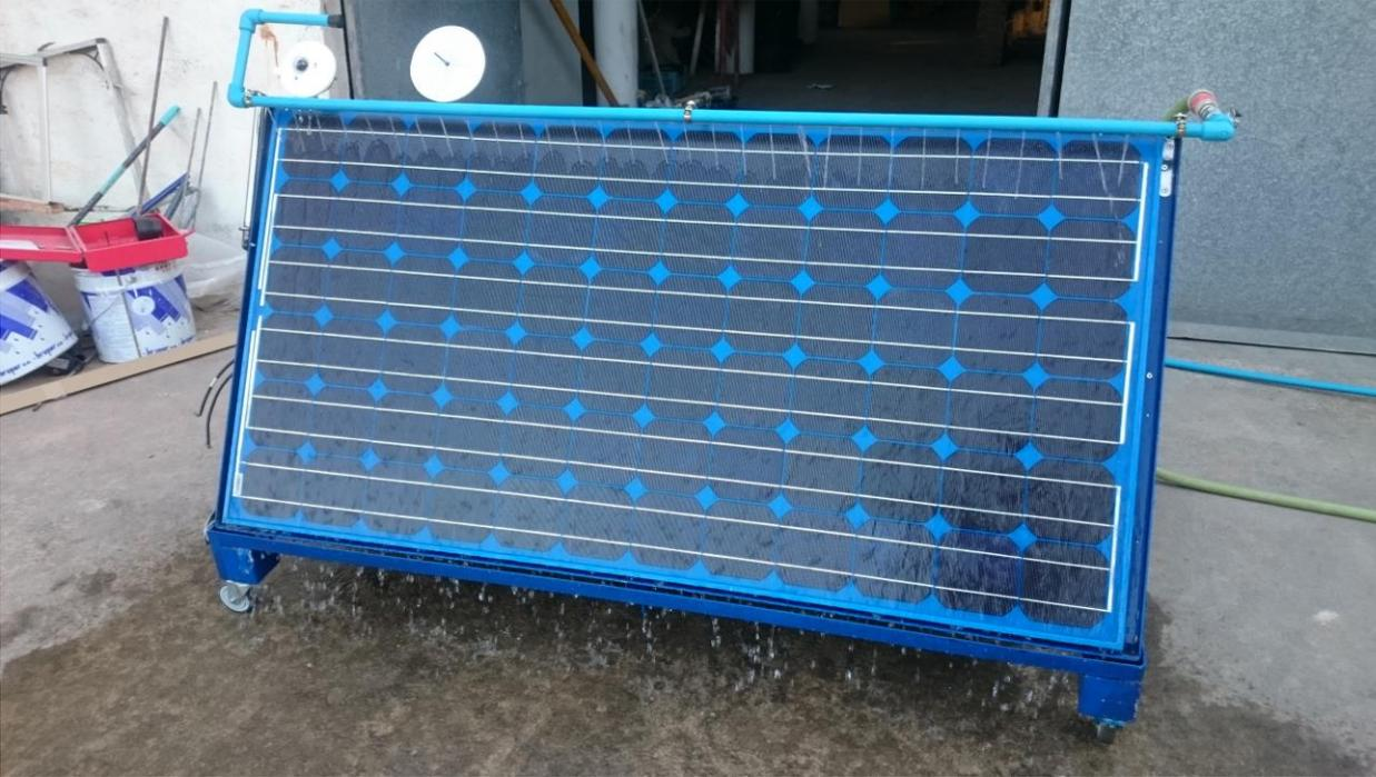
Imagen 27: Estado final estructura con el flujo de agua activo
