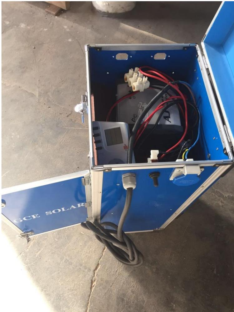
Imagen 19: Interior armario e instalación interruptor GCE Solar
