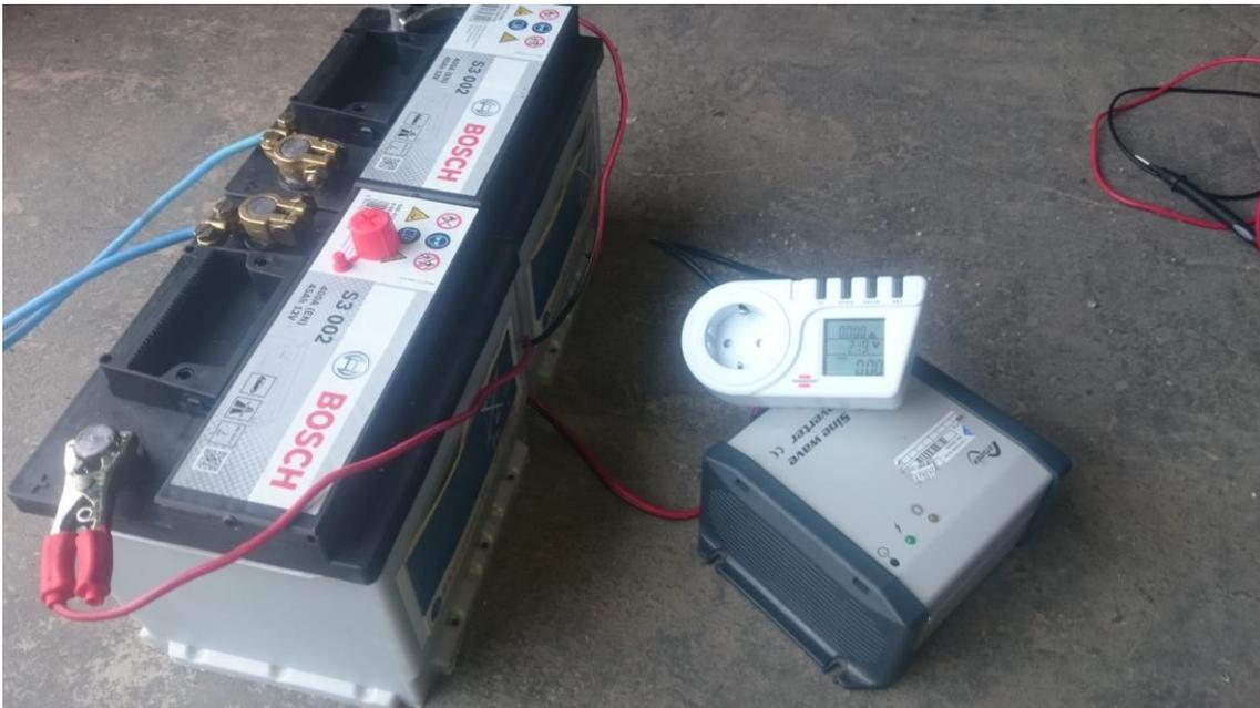
Imagen 29: Verificación funcionamiento inversor y baterías
