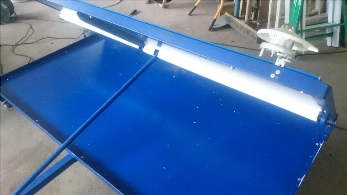
Imagen 17: Ubicación, sellado y remachado de chapa laminada inferior
