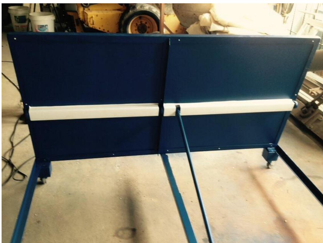
Imagen 16: Sellado de regleta para ocultar elementos de transmisión y cableado de placa FV
