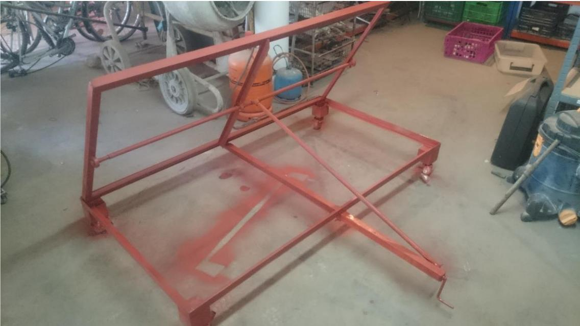
Imagen 12: Proceso de imprimación en estructura desnuda
