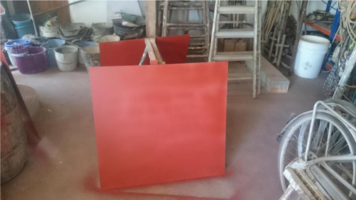
Imagen 11: Proceso de imprimación en chapas laminadas
