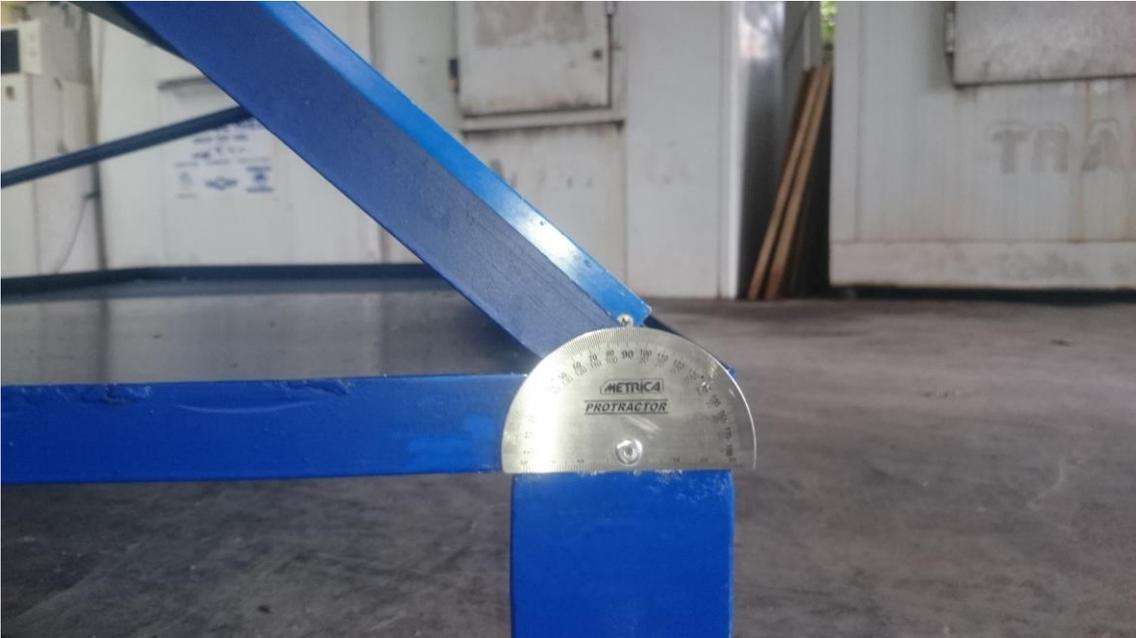
Imagen 23: Ubicación transportador para conocer inclinación placa FV
