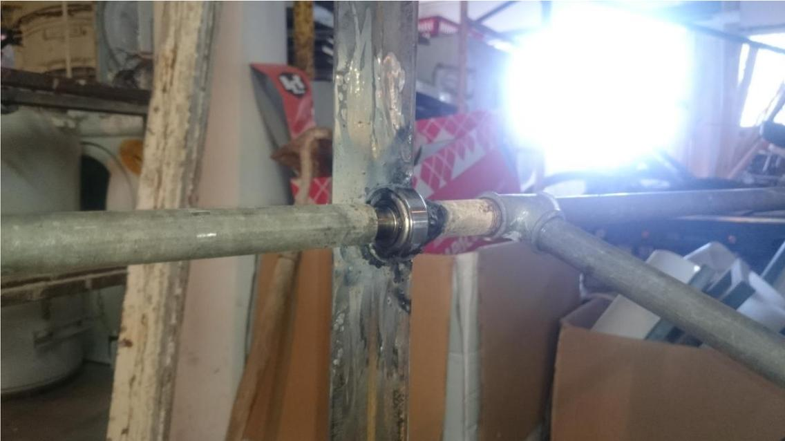
Imagen 5: Ubicación y soldado de rodamiento central en parte inclinable
