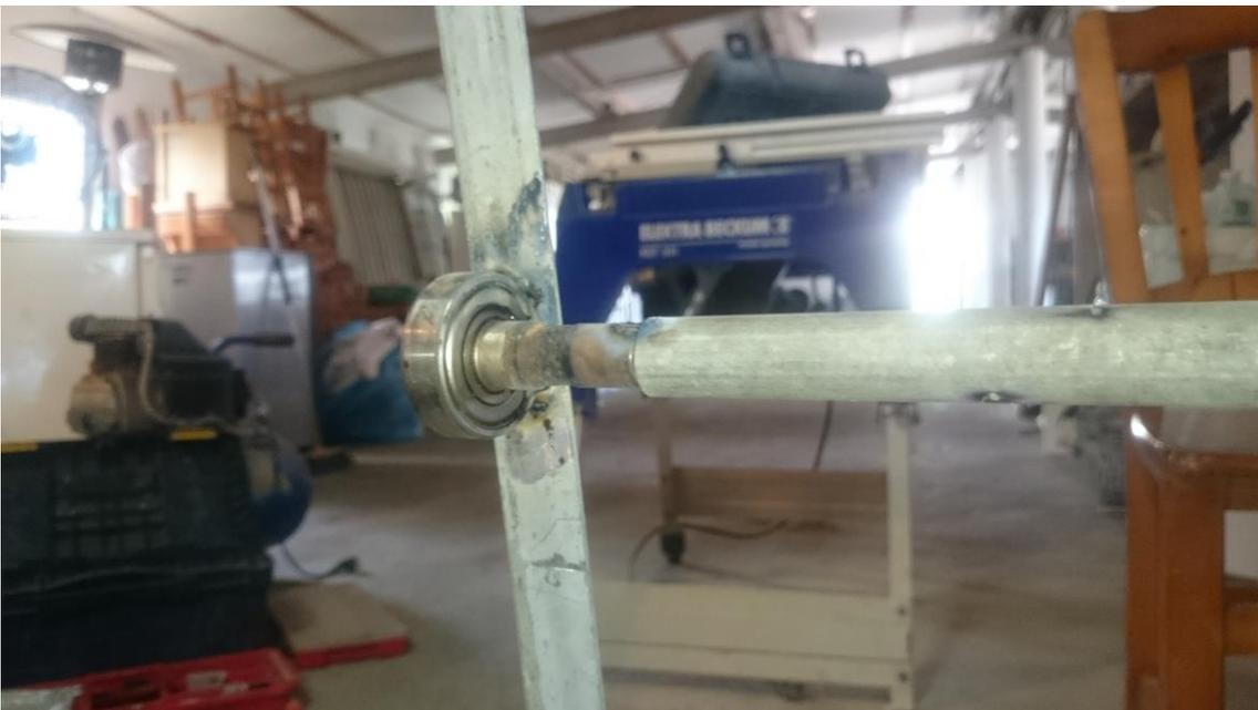
Imagen 4: Ubicación y soldado de rodamiento izquierdo en parte inclinable
