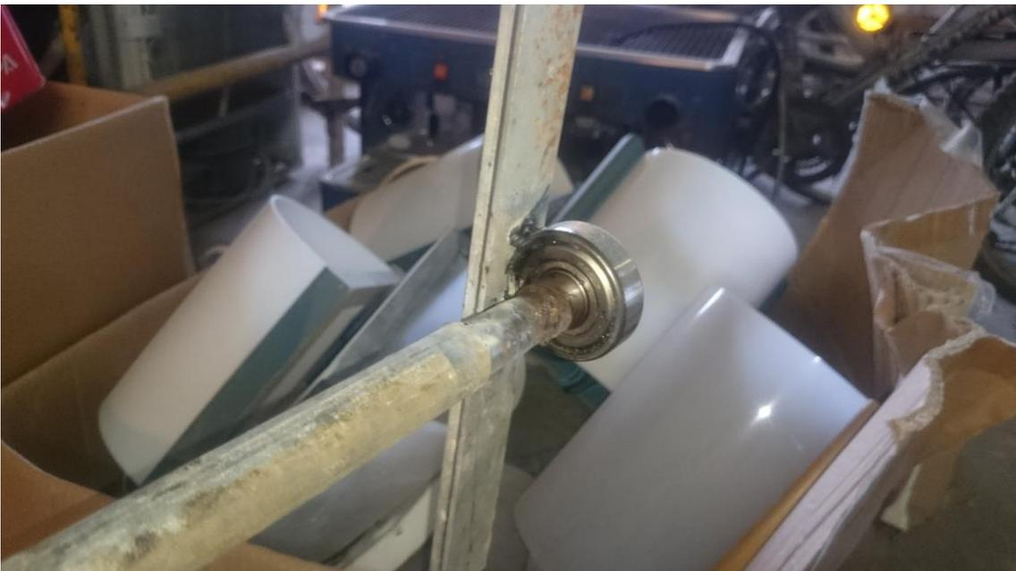
Imagen 6: Ubicación y soldado de rodamiento derecho en parte inclinable
