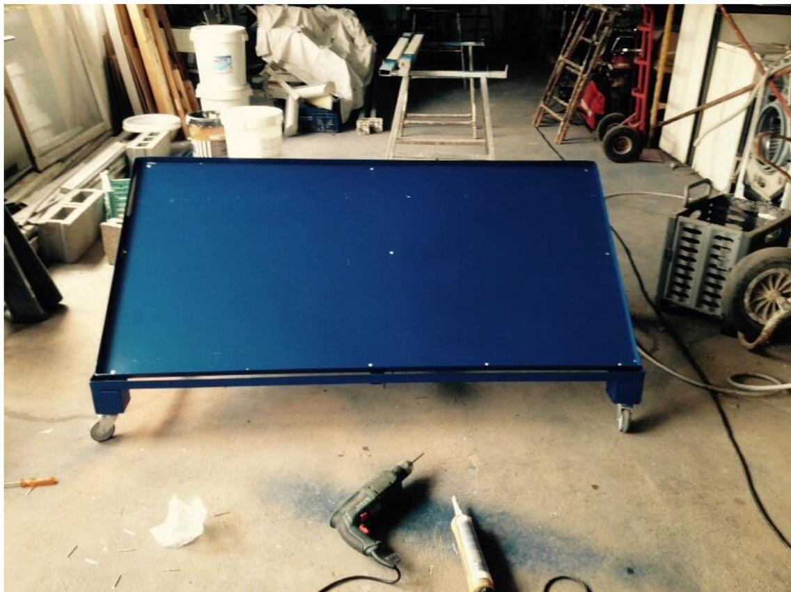
Imagen 15: Ubicación, sellado y remachado de chapas laminadas
