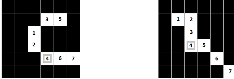
Figura 4.14: Ejemplos del orden de los píxeles blancos al leer la imagen. El correspondiente píxel central está recuadrado en gris.
